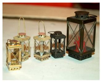
Eine kleine Auswahl der Laternen, zusammen mit der grossen Schwester im Massstab 1:8. Es fehlen nur noch die Scheiben und der Petroleumleuchter. Die Unterseite der Laterne muss quadratisch auf etwa das Mass 7 X 7 mm aufgefeilt werden. Durch diese Öffnung werden die Scheiben eingesetzt und zum Schluss - der Petroleumleuchter.
