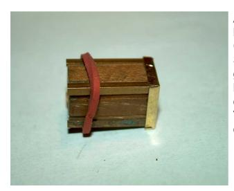
Als Löthilfe wird hier das Holz-Formteil benötigt, in der abgebildeten Weise. Der Gummiring sichert die seitlichen Streben. Ist dieser Lötvorgang gelungen, wird das Holz-Formteil herausgenommen und die Lötung auf der anderen Seite durchgeführt. Etwas Vorsicht ist angebracht, sonst lösen sich die Lötstellen gegenüber.
