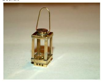
In gleicher Weise wird das obere runde Teil (Abzugshaube) aufgelötet, ebenfalls unter Zuhilfenahme eines kleinen Holz-Formteils mit Zapfen. Anschließend wird das Gehäuse gebohrt, der Griff gebogen und auf der Innenseite der Abzugshaube mit einer Zange angequetcht - damit dieser Halt findet. Zum Schluss noch den Deckel auflöten - das Gehäuse ist fast fertig.
